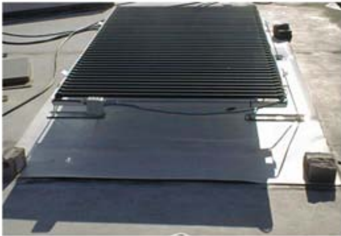
Abb.5: CIGS-Röhren bewirken Vollverschattung des Reflektors
