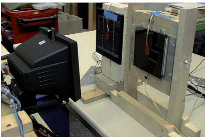
Abb. 1.: Herunter skaliertes Experiment: Kleinstmodule, links polykristallin, rechts amorphes Silizium (Dünnschicht).
