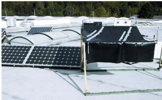
Abb. 5: Beispiel für spaltenweise Verschattung. Hierbei wurden die 6 rechten Spalten eines Moduls verschattet. Die restlichen 5 unverschatteten Module des Strangs befinden sich links vom teilverschatteten Modul (nicht auf dem Foto sichtbar).
