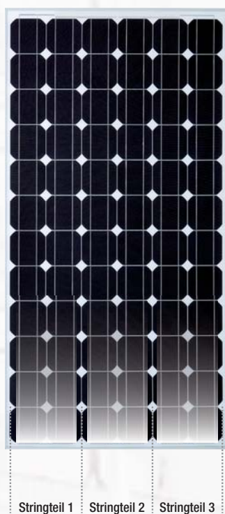
Abb. 3: Reale Stringteilzuordnung pro verwendetem Modul
