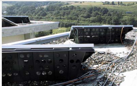
Abb. 7: Testsystem ist auf hinterlüfteten Wannen montiert
