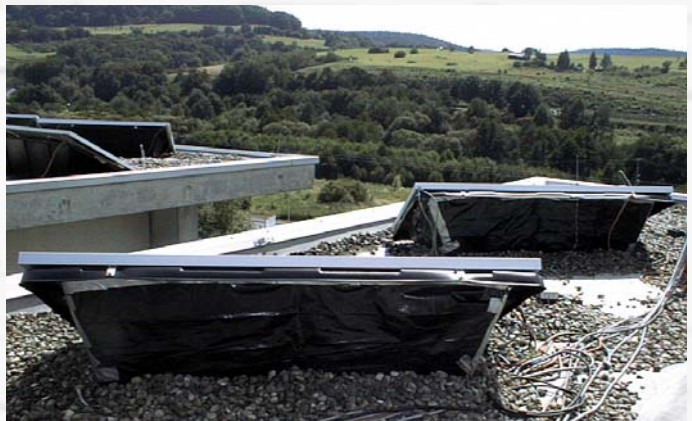
Abb. 10: Wannen des Testsystems komplett mit schwarzer Folie verklebt
