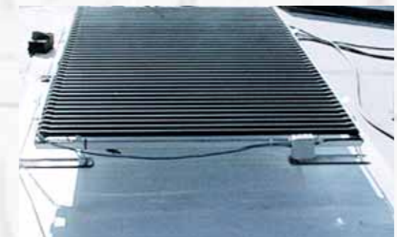
Abb. 5: CIGS-Röhren bewirken Vollverschattung des Reflektors
