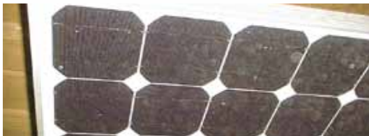
Abb. 16: Unterseite ist nach ca. 4 Wochen nur leicht verschmutzt
