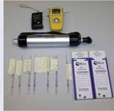
Abb. 12: Im Vordergrund: Mess-System der Fa RAE mit Prüfröhrchen und Gasspürpumpe; im Hintergrund: testo 174H und GasAlert Extreme
