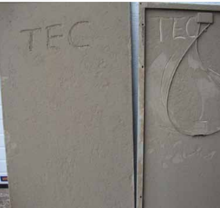
Abb. 18 und 19: Schmutzschicht nach 6 Monaten
