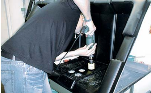
Abb. 3: Bohren der Lüftungslöcher
