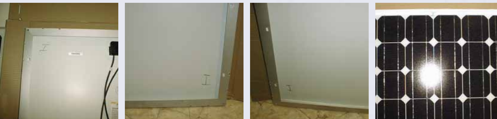
Abb. 1 bis 4: Ausgangszustand des Moduls AS M 180
