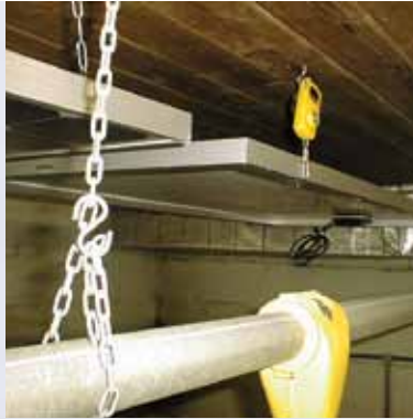
Abb. 11: GasAlert Extreme zur Messung der Ammoniak-Konzentration
