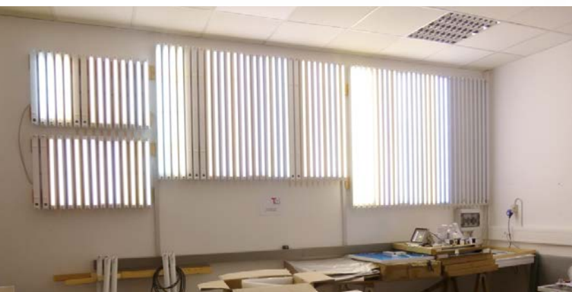
Abb. 4: Testwand für Langzeituntersuchungen (Dauertest und Zyklfestigkeit).
