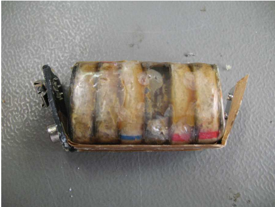
Abbildung 7: Geöffnete 9 V Blockbatterie.
