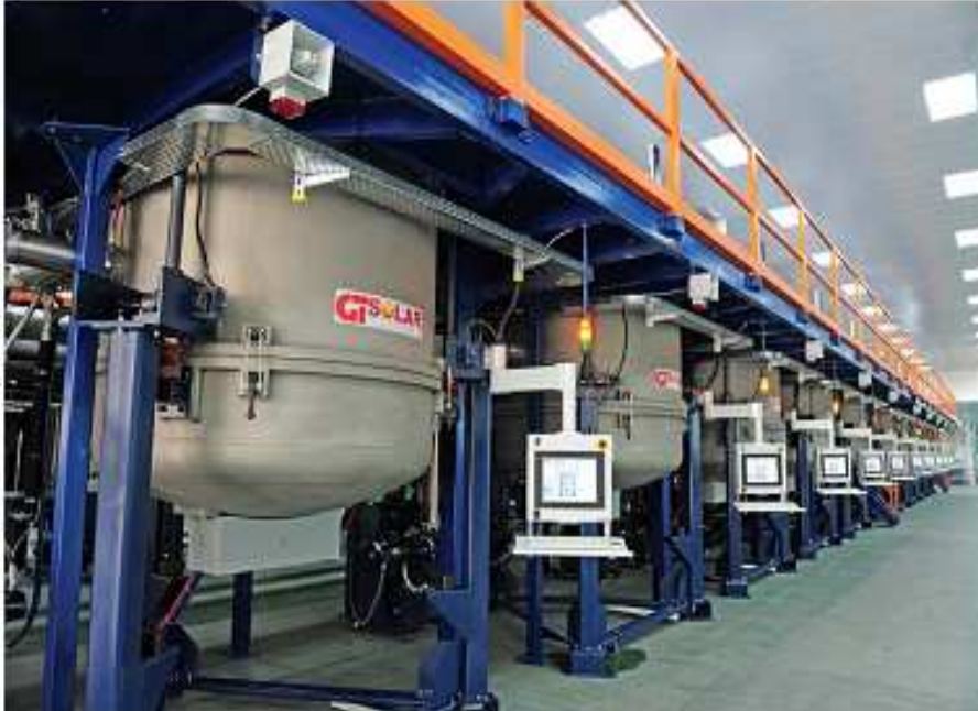
Abbildung 3: Öfen für monokristalline Module in dem chinesischen Werk.
