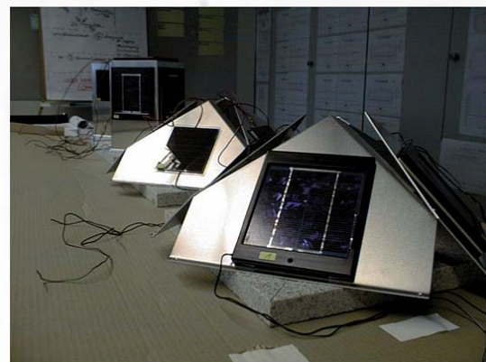
Im Langzeitversuch wird die Performance in verschiedenen Neigungswinkeln getestet
