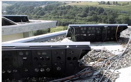
Abb. 7: Testsystem ist auf hinterlüfteten Wannen montiert
