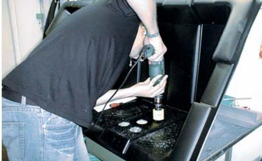
Abb. 3: Bohren der Lüftungslöcher
