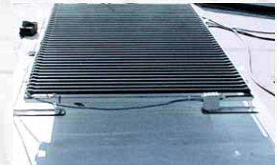
Abb. 5: CIGS-Röhren bewirken Vollverschattung des Reflektors
